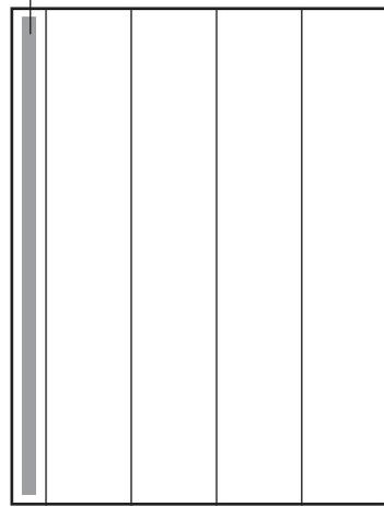
均等幅でプラダンの表面にだけ切り込みを入れて曲がるようにする
